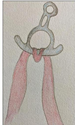
4) Fädel Deine Vertikaltuchmitte durch das gleiche, große Loch Deines Figurachers wieder hindurch (Achtung, dass ist sehr eng und etwas knifflig, geht aber!). Nun lege Deine Vertikaltuchmitte um das obere Ende Deines Figurachers
